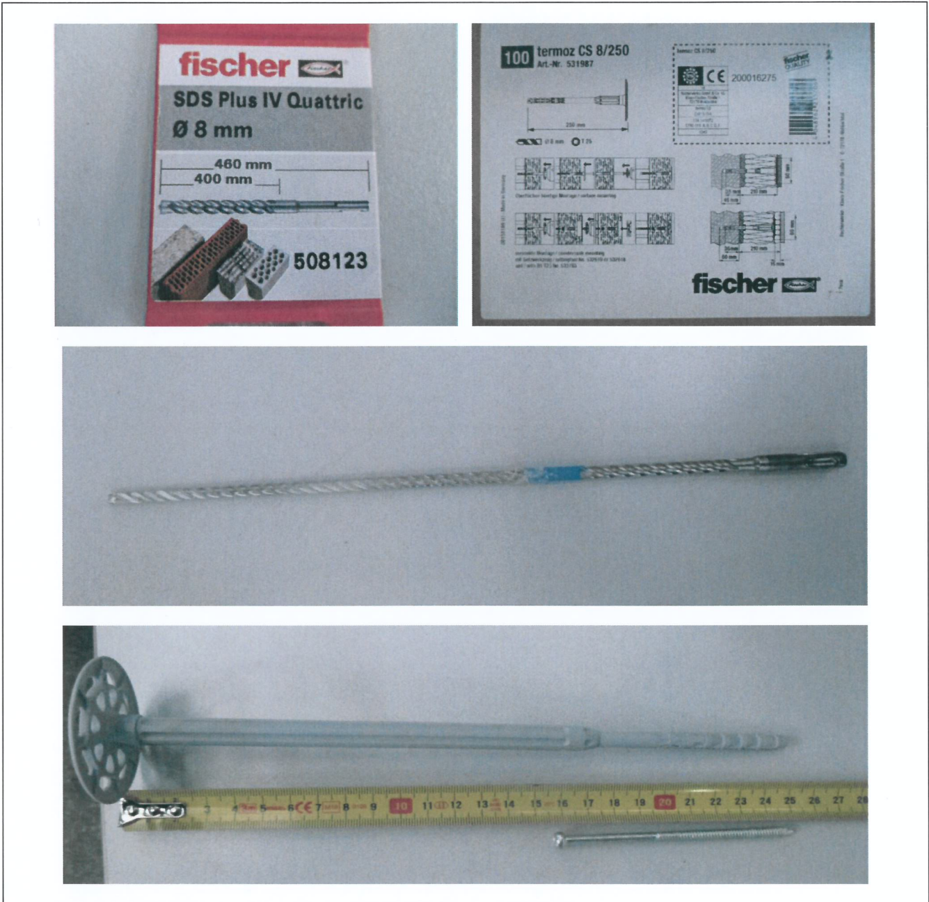
Photo 2 : Éléments de fixations utilisés, et chevillage des panneaux
